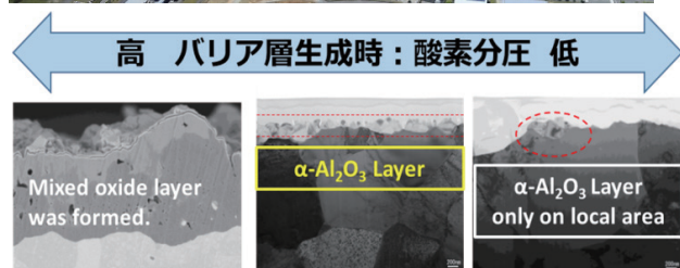
図 7 酸素バリア層形成条件 (上:SPring-8、下:酸素分圧 vs バリア層形成状況)
