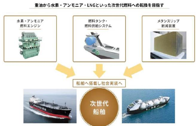
アンモニア燃料船の開発の目的は、合理的に温室効果ガス削減効果が得られる範囲でアンモニア燃料の使用比率の高いエンジンや燃料タンク・燃料供給システムに係る要素技術開発を行い、2028 年までのできるだけ早期に商業運航を実現することである。
