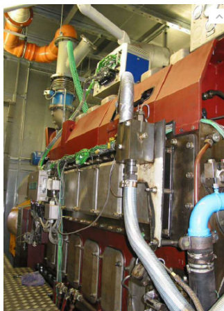
写真 4 将来燃料試験準備中の中型 6 筒試験エンジン
